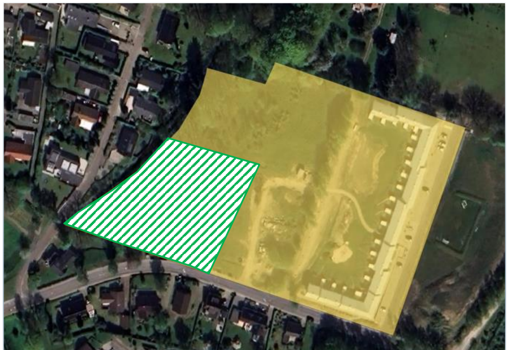
Figur 1 Lokalplanområdet 1114, hvor den skraveret del er udlagt til fjernvarme og resten er projektområdet uden kollektiv forsynings status.
