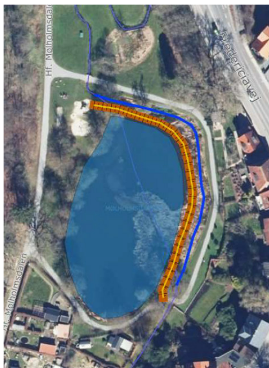
Figur 1: Oversigtskort. Det nye forløb for Mølholm Å er markeret med blå streg. Mellem søen og det nye forløb etableres et dike (gul-brun markering).
