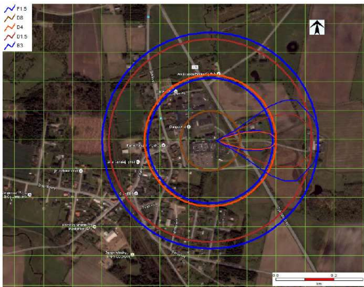
Figur 13 Effektafstande og skykontur for AEGL3 (1600 ppm i 30 minutter) for udslip fra 21 mm hul mellem kondensator og receiver. Udslipshøjde 5 m, Konturer beregnes i 1 m over jordniveau, beregningsmodellen tager ikke højde for bygningen.
