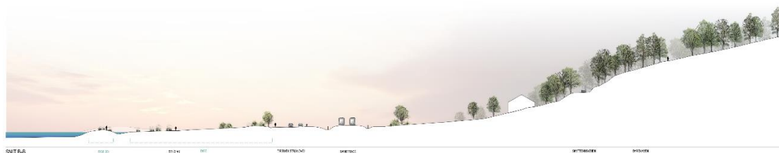
Figur 32: Tværsnit af Membranen med illustration af det landskabelige dige med stiforbindelse for situationsplanen snit B-B. Kilde: COWI/Arkitema
