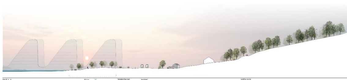
Figur 31: Tværsnit af Membranen med illustration af det landskabelige dige med stiforbindelse for situationsplanen snit A-A. Kilde: COWI/Arkitema
