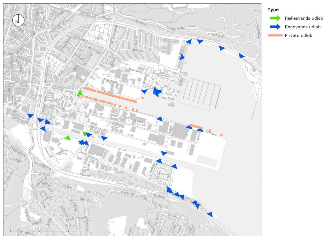
Figur 102: Udløb fra kloak- og spildevandsledninger. Datakilde: LER
