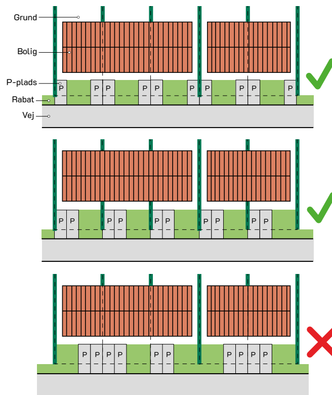
Figur 5 Eksempler på placering af p-pladser og overkørsler på maksimalt 6 meter i bredden.
