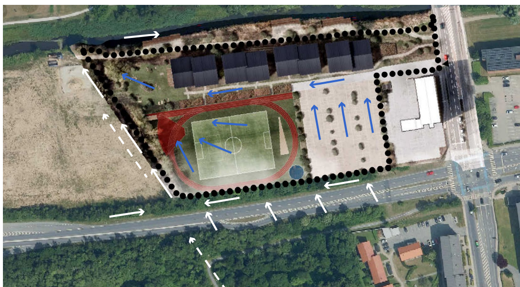
Figur 12: Illustration viser strømningsveje for regn- og overfladevand med afledning til Vejle Å. De blå pile viser strømningsveje i lokalplanområdet. De hvide pile viser hvorledes vand bevæger sig omkring lokalplanområdet og via grøften langs lokalplanområdets vestligste grænse. De stippled pile viser hvorledes vand afvander i rør under grøften.
