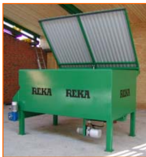
3,5 – 5 M 3 Hydraulisk magasin med låg.
