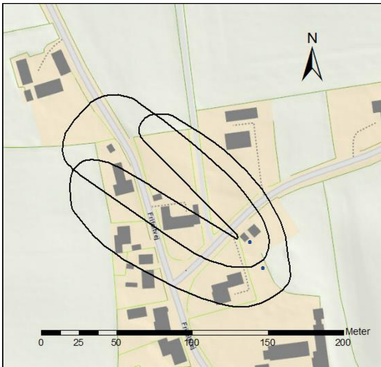
Boringsnære beskyttelsesområder for Håstrup Vandværk
